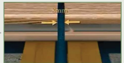
9. บริเวณหัวแผ่นของไม้พื้นควรเว้นระยะไว้ 8 มม.
